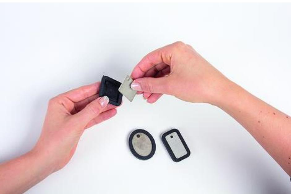
La **température** et l'**humidité** sont déterminantes pour le temps de séchage. Il est toutefois conseillé de démouler la remorque le **lendemain**. La face supérieure, c'est-à-dire la dernière face arrière, peut être séchée avec une **papier de verre** le redressement et le lissage.
